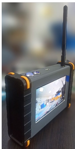
Прототип устройства обнаружения аналогового видеосигнала
