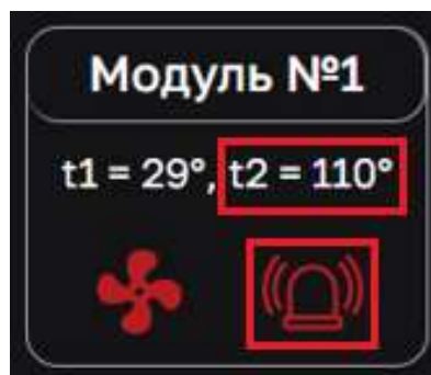
Рисунок 31 Отображение повышения температуры второго радиатора Модуля №1 и значок аварийного сигнала
