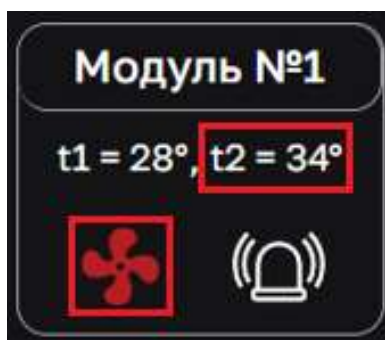
Рисунок 30 Отображение повышения температуры второго радиатора Модуля №1 и значок запуска вентиляторов
