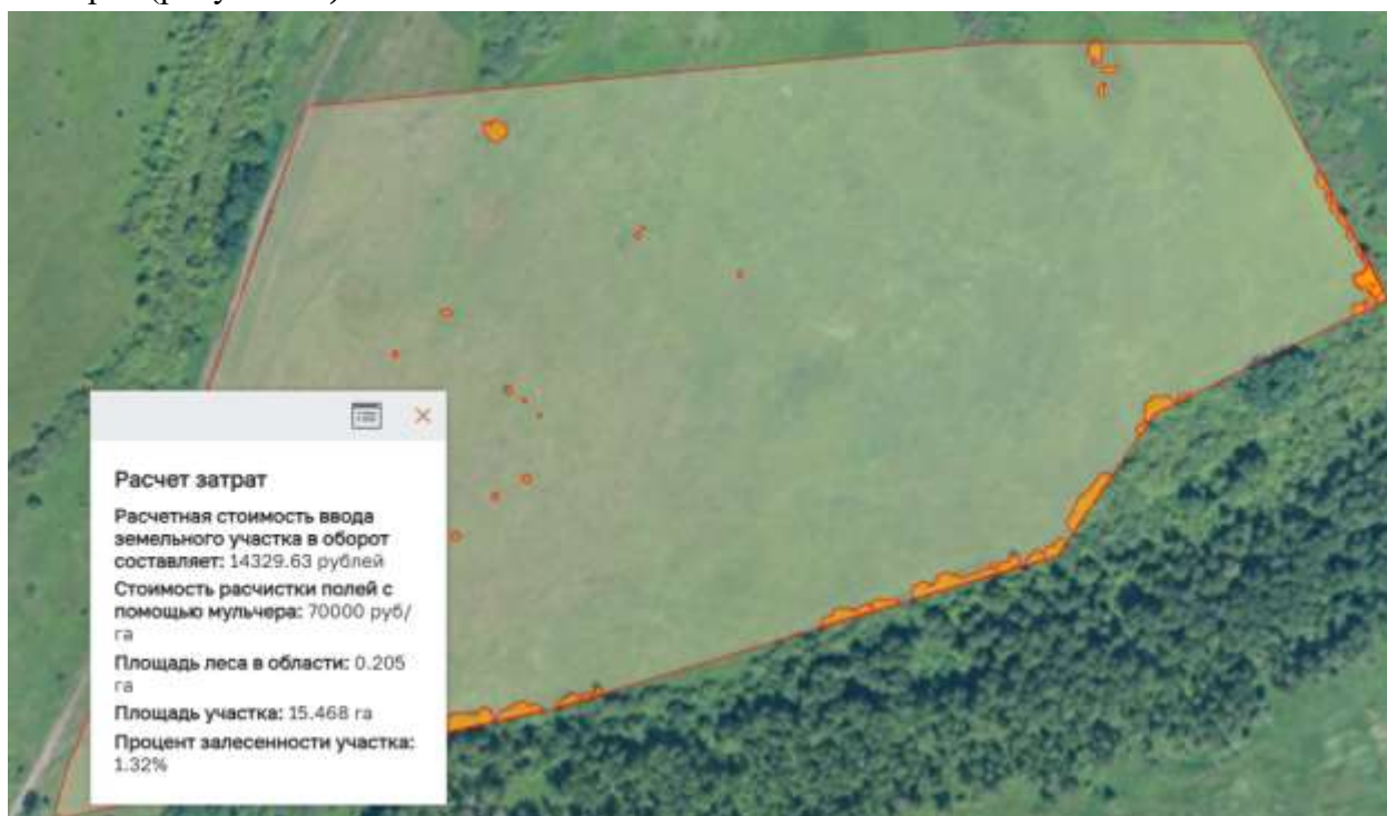
Рисунок 39 - Выбор области в которой система будет производить расчет
