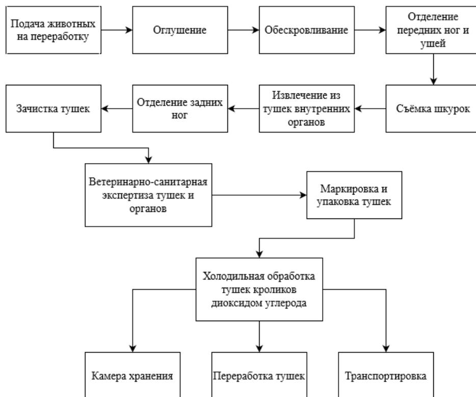
Рисунок 4.3 – Технологическая схема убоя и переработки кроликов
