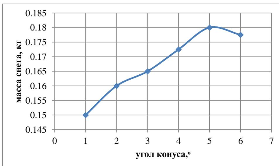
Рисунок 3.10 – Характеристика выхода снега при температуре жидкого диоксида углерода  $10\pm 1$  °C
