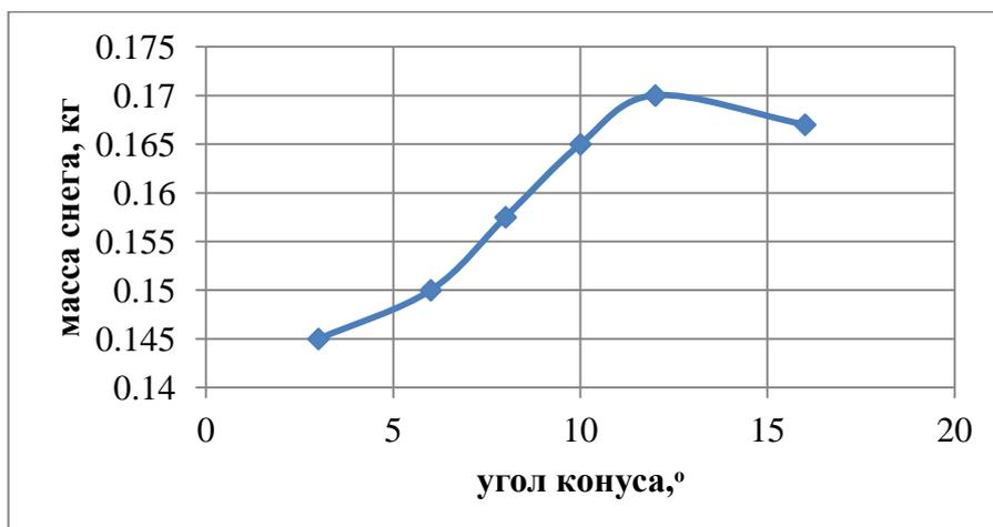
Рисунок 3.12 – Характеристика выхода снега при температуре жидкого диоксида углерода  $0\pm 1^\circ\text{C}$
