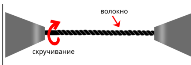
Рисунок 3.7 – Процедура механического уплотнения волокна с помощью скручивания
