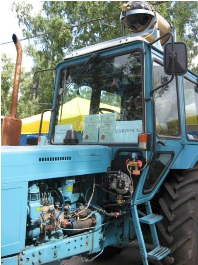
Рисунок 3.5 – Опытный трактор МТЗ-82 с газодизельной системой питания: а – общий вид; б – моторный отсек
