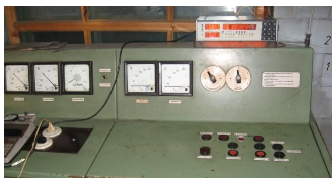
Рисунок 3.7 – Пульт управления электротормозным нагрузочным стендом RAPIDO: 1 – пульт управления; 2 – аппаратура МИВА-С
